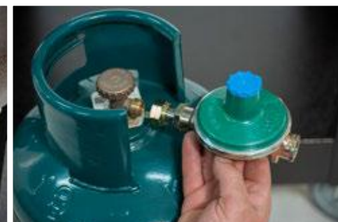
2. Avvitare il regolatore del gas nella valvola della bombola e, a mano, girare in verso antiorario il bullone. Aiutarsi con una chiave apposita per regolatore del gas per il perfetto serraggio e per evitare di danneggiare la guarnizione della valvola compromettendo la tenuta stagna.
