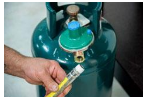
3. Collegare il tubo flessibile con il regolatore di pressione.
